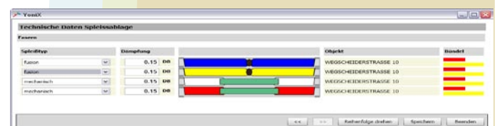
Bild: Spleißablage SOSA2 mit Fasern, Spleißtypen und Dämpfungswerten
